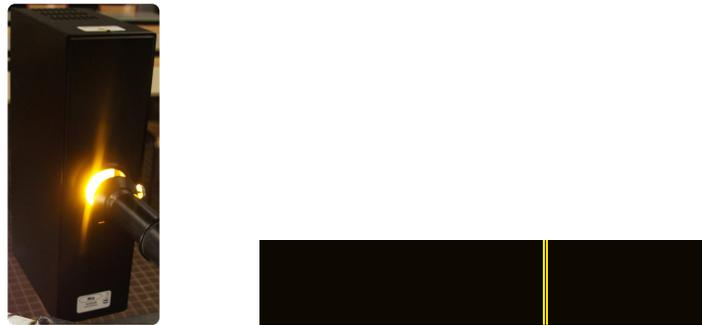
FIGURE 2.4 – Une lampe à décharge à vapeur de sodium et son spectre d'émission
