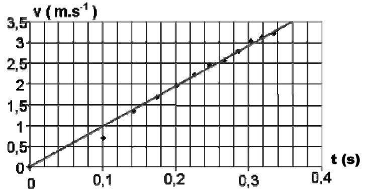
On doit calculer le coefficient directeur de la droite :  $k = a = \frac{2.78 - 0}{0.286 - 0} = 9.7 \text{ m.s}^{-2}$
