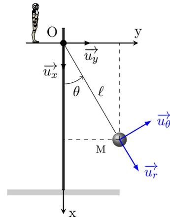
FIGURE 4 – Pendule simple et base polaire
