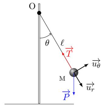
FIGURE 5 – Forces s'exerçant sur le pendule simple
