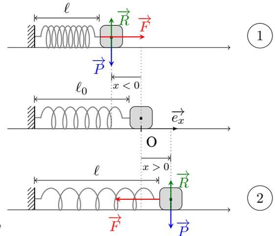
FIGURE 1 – Forces s'exerçant sur la masse accrochée au ressort horizontal
