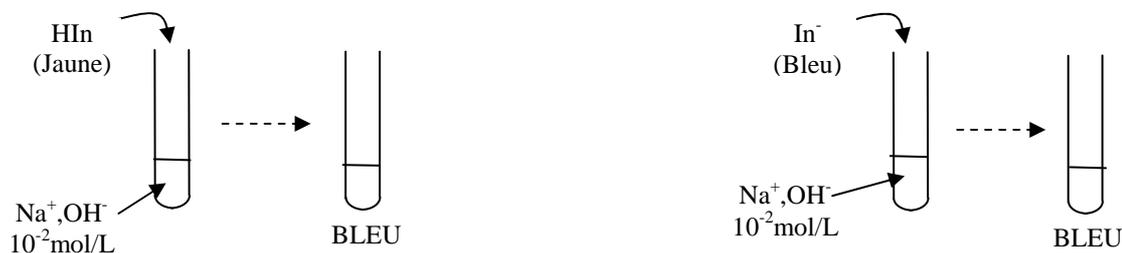
La réaction qui marche est celle entre un acide et une base. Transfert de proton  $\text{H}^+$  entre le couple  $\text{HIn}_{(\text{aq})} / \text{In}^-_{(\text{aq})}$  et le couple  $\text{H}_2\text{O}_{(\text{l})} / \text{OH}^-_{(\text{aq})}$
