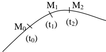
$$V_1(t) = \frac{\text{longueur } \overline{M_0M_2}}{t_2 - t_0} \approx \frac{M_0M_2}{t_2 - t_0}$$
