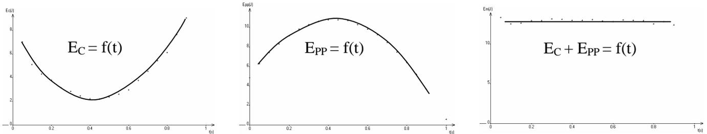
Il y a une nouvelle fois **conversion d'énergie cinétique en énergie potentielle et inversement**.
