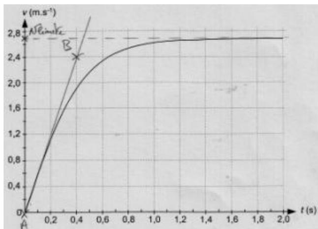
5.1. Pour trouver  $v_{\text{lim}}$ , on trace l'asymptote à la courbe  $v=f(t)$  quand  $t$  tend vers l'infini ; cette asymptote coupe l'axe des ordonnées en un point qui donne la valeur de la vitesse limite :  $v_{\text{lim}} = 2.7 \text{ m.s}^{-1}$
