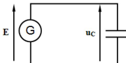
2.2.3.  $u_C$  reste égale à  $E$  quelque soit la distance entre les armatures du condensateur, or d'après  $q = C \times u_C$ , si  $C$  augmente ( $d$  diminue) alors  $q$  augmente.
