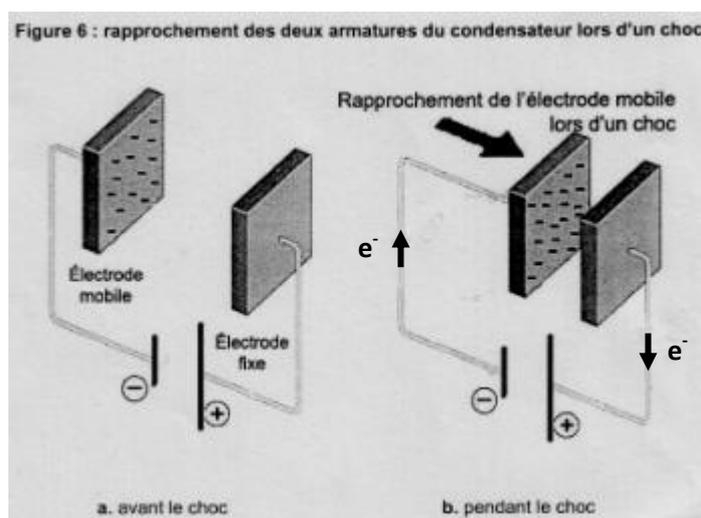
2.4. On a la relation  $i = \frac{dq}{dt}$ , il faut choisir la proposition b) : la détection d'une variation d'intensité du courant dans le circuit commande le déclenchement du gonflage de l'airbag.
