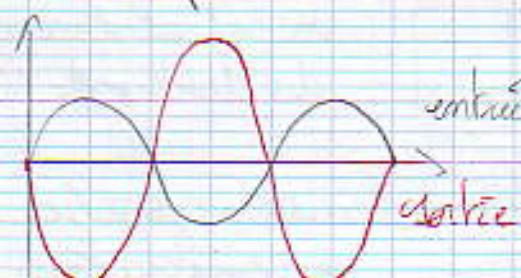
la tension de sortie est amplifiée et inversée
