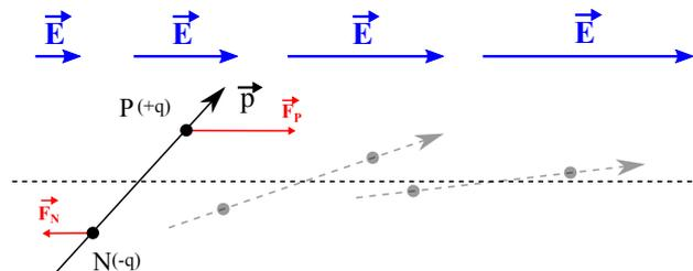
FIGURE 7 – Déplacement et alignement d'un dipôle dans un champ extérieur non uniforme
