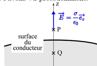
FIGURE 2 – Champ à la surface d'un conducteur
