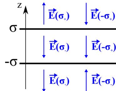
FIGURE 4 – Champ électrostatique créé par un condensateur plan
