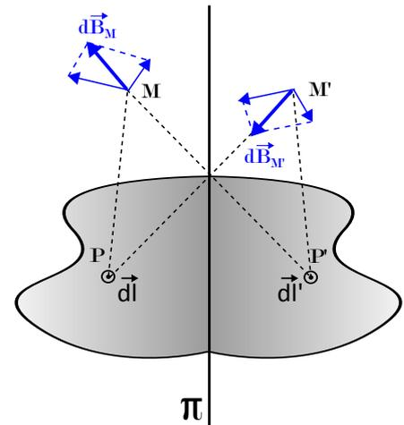
FIGURE 5 – Champ magnétique anti-symétrique avec un plan de symétrie
