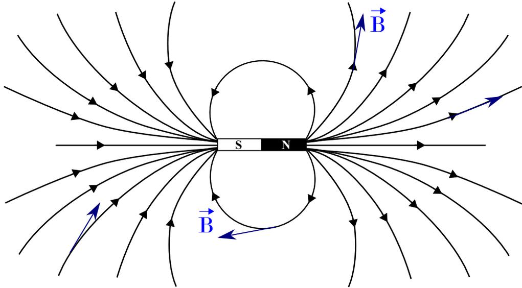
FIGURE 3 – Spectre magnétique d'un aimant droit
