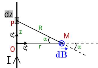
FIGURE 8 – Schéma de situation pour le calcul du champ magnétique créé par un fil infini
