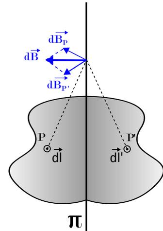
FIGURE 4 – Champ magnétique et plan de symétrie
