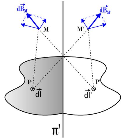
FIGURE 7 – Champ magnétique symétrique avec un plan d'antisymétrie
