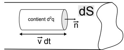
FIGURE 1 – Volume élémentaire d'un conducteur électrique
