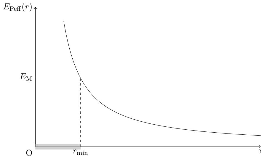
FIGURE 3 – Allure de  $E_{\text{Peff}}(r)$  dans le cas d'une force répulsive
