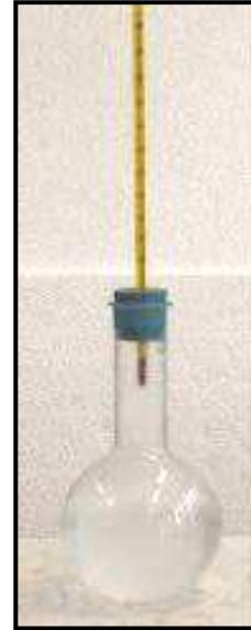
On bouche alors le ballon avec son bouchon muni d'un thermomètre (qui indiquera rapidement une température proche de 100°C, celle-ci diminuant par la suite)
