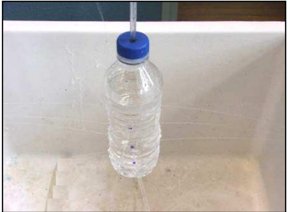
En actionnant le piston de la seringue, on se rend compte, grâce au filet d'eau éjectés par les petits trous formés dans la bouteille, que la direction des forces de pression est normale, perpendiculaire aux parois
