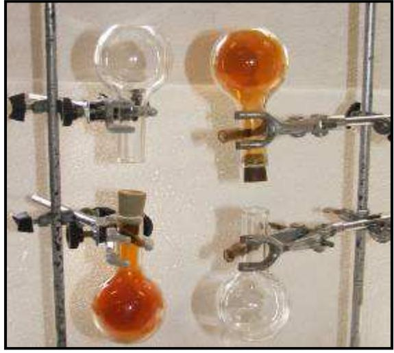
Le gaz roux, dioxyde d'azote de formule NO<sub>2</sub> est créé dans les ballons grâce à la réaction entre la tournure de cuivre et l'acide nitrique concentré
