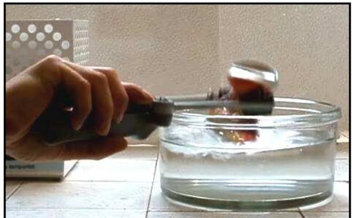
**Au contact de l'eau froide, la vapeur à l'intérieur de la canette se condense pour se transformer en liquide : il ne reste que du vide dans la canette, elle s'écrase alors sous l'effet de la pression atmosphérique**
